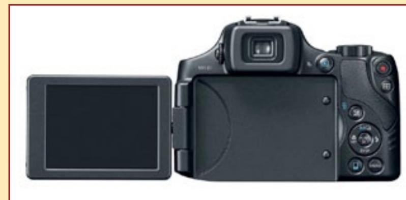
Al display orientabile da 3" e 922.000 pixel di risoluzione, orientabile in tutte le direzioni, la fotocamera abbinata un mirino elettronico di alta qualità. A destra, il quadro comandi, con il pulsante in alto per avviare la registrazione video
