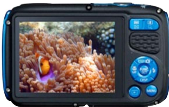
Il monitor della PowerShot D30 è un LCD da 3 pollici e 461.000 pixel di risoluzione. La buona definizione assicura comfort sia in fase di ripresa, sia di revisione delle immagini. I pulsanti sono di dimensioni generose e facili da gestire anche con i guanti
