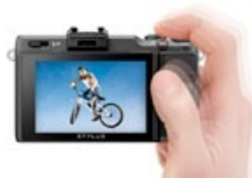
La funzione Dual Image Stabilisation offre doppia protezione contro le immagini mosse a causa del movimento della fotocamera e della velocità dei soggetti. Combina elevati valori ISO con uno stabilizzatore meccanico associato al sensore d'immagine. Un sistema giroscopico rileva il movimento della macchina e apporta le correzioni al sensore
