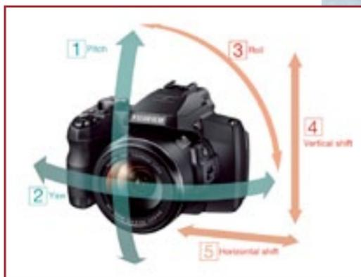
Lo stabilizzatore ottico (Lens shift type) compensa il movimento della fotocamera lungo cinque direzioni, assicurando scatti e riprese stabili anche mentre si cammina o si sottopone la macchina a sollecitazioni
