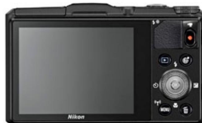
Fra i simboli che si osservano sul retro della fotocamera c'è il planisfero che attiva sul display la mappa digitale; l'antenna ricorda le funzioni Wi-Fi integrate. Il navigatore circolare, molto comodo, lo si utilizza ruotandolo o premendolo
