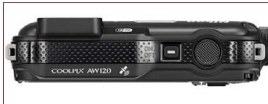
Osservando dall'alto la macchina, si notano i loghi che indicano la presenza del sensore GPS/GLONASS integrato e del modulo Wi-Fi. L'obiettivo è a scorrimento interno per cui lo spessore della macchina, solo 25.8mm, resta invariato anche quando è accesa
