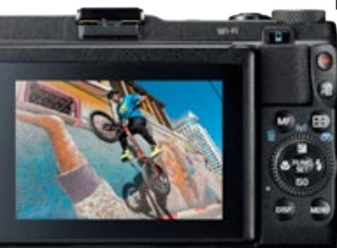
I comandi sul retro possono essere personalizzati in base al nostro modo di fotografare. In alto, la scritta WiFi ricorda che la G1 X Mark II integra un modulo WiFi e la tecnologia NFC per connettere facilmente la fotocamera a smartphone e tablet. Utilizzando l'app CameraWindow Canon è possibile gestire la fotocamera da remoto
