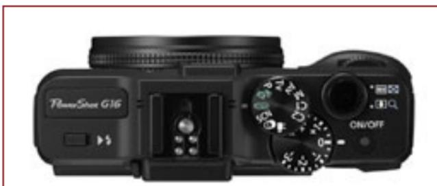
Compatta ed ergonomica, la G16 fornisce tutte le funzionalità utili a chi desidera una fotocamera piccola, ma dalle prestazioni elevate. In alto la comoda ghiera dei programmi con accanto quella per la sovra/sottoesposizione, il flash integrato e la slitta per accessori esterni. Sul retro l'ampio Lcd, ma anche il mirino ottico, e la classica pulsantiera
