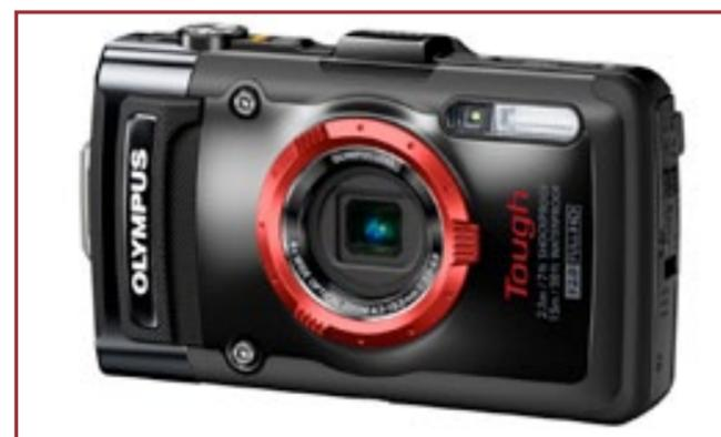
La Stylus TG-2 ha un corpo macchina molto robusto, progettato per resistere a tutto: doppie guarnizioni a tenuta stagna e doppio sistema di chiusura per garantire la massima sicurezza contro agenti esterni, polvere, cadute e freddo intenso. Integrati anche GPS e bussola
