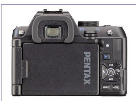
La fotocamera offre uno schermo LCD orientabile in ogni posizione, trattato con un particolare rivestimento (Air Gapless) in resina posto tra il pannello e lo schermo per evitare riflessi; c'è anche il mirino ottico a pentaprisma con copertura al 100% e ingrandimento di 0.95%. All'interno della fotocamera è stato inserito il sistema anti vibrazioni Shake Reduction per evitare il micro mosso.
