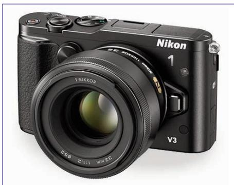
Compatta, ottiche intercambiabili, ma soprattutto un potente processore, l'Expeed 4A associato al sensore Cmos da 18 Mega privo di filtro low-pass. Un abbinamento che intende assicurare la qualità delle immagini e la rapidità operativa. E' la nuova Nikon 1 V3 che per la prima volta nella gamma propone un ampio schermo Lcd con funzioni touch e basculante. Display da 3" e oltre 1 milione di pixel.
