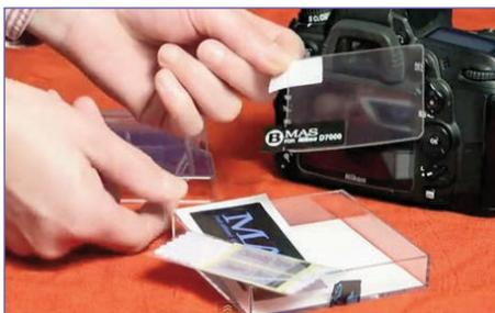
I copri-monitor possono essere montati sul display in modo rapido e veloce. Non si utilizzano adesivi e quindi, quando si tolgono, non lasciano alcuna traccia sulla superficie dello schermo. E' necessario pulire accuratamente il display prima del montaggio sfruttando anche le strisce antistatiche e la salvietta detergente fornita a corredo. Per vedere come si fa, guarda il video:
