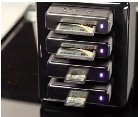
Una sola porta USB, ma quattro moduli dove inserire contemporaneamente 4 diverse card di memoria. E' la nuova soluzione Lexar Professional Workflow Reader HR1. In pratica un lettore dotato di 4 slot che collegato al computer tramite l'unica porta Usb disponibile permette di avere le 4 card immediatamente leggibili e in contemporanea. Un'idea semplice, ma molto utile per chi usa diversi tipi di scheda da differenti apparecchi. Non solo.
