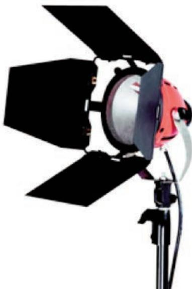
L'illuminatore DG-800 è versatile e ben costruito, con un portalampada in ceramica e il riflettore a specchio in alluminio. Oltre a poter regolare la potenza della luce, ha un comando spot-flood nella parte posteriore che permette di ottenere un angolo di illuminazione più o meno ampio. In funzione delle necessità.
