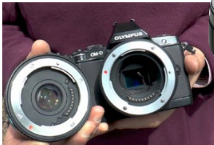
Olympus MF-2, l'adattatore per fotocamere Pen e OM-D. Grazie a questo accessorio è possibile montare le ottiche OM sulle fotocamere Micro Quattro Terzi. Pesa pochissimo, appena 78gr.
