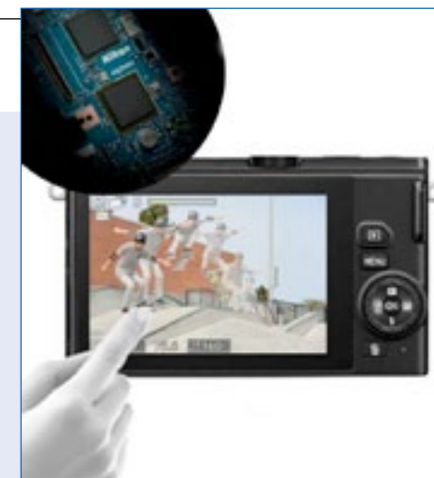
Il grande LCD da 3 pollici touch da 1.037k occupa la maggior parte del retro della fotocamera. Attraverso lo schermo è possibile mettere a fuoco semplicemente sfiorando la sua superficie, sia in foto sia in video
