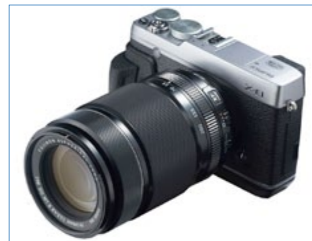
Nel Fujinon XF55-200mm f/3.5-4.8R LM OIS, durante la zoomata la parte interna dell'obiettivo si estende, mentre la messa a fuoco interna impedisce all'obiettivo di ruotare. Ciò permette l'utilizzo di filtri polarizzatori da 62 mm. A sinistra, montato sulla X-E1
