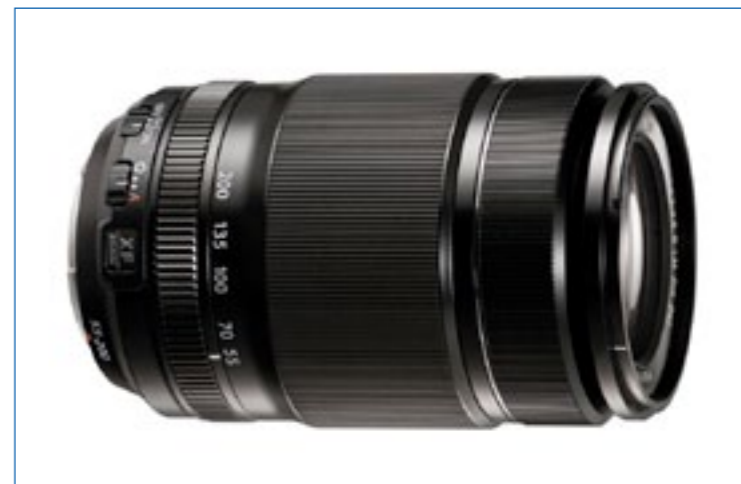
Nel Fujinon XF55-200mm f/3.5-4.8R LM OIS, durante la zoomata la parte interna dell'obiettivo si estende, mentre la messa a fuoco interna impedisce all'obiettivo di ruotare. Ciò permette l'utilizzo di filtri polarizzatori da 62 mm. A sinistra, montato sulla X-E1
