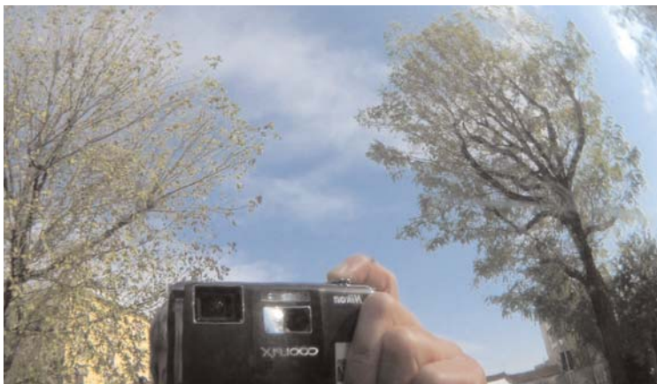
La Coolpix S1000pj è una compatta tradizionale, con una particolarità: il proiettore incorporato. Sul davanti in alto a destra, lo zoom 5x, equivalente a 28-140 mm, interamente integrato nel corpo macchina; sulla sinistra, l'obiettivo del proiettore. Si può proiettare da una distanza massima di 2 metri per immagini grandi fino a 40"
