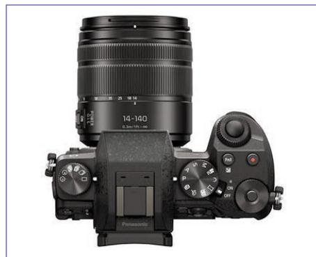
La Lumix G7 sfrutta le capacità di un sensore Micro Quattro Terzi Digital Live MOS da 16 Mega e del processore Venus Engine con architettura quad-core in grado di gestire sequenze fino a 8fps in AF singolo e a 6fps in AF continuo. Lo stesso motore, afferma il produttore, fornisce una migliore resa cromatica rispetto al passato. Dal canto suo il sistema Multi-Process Noise reduction (NR) aiuta a ridurre il rumore, anche alle sensibilità più elevate.
